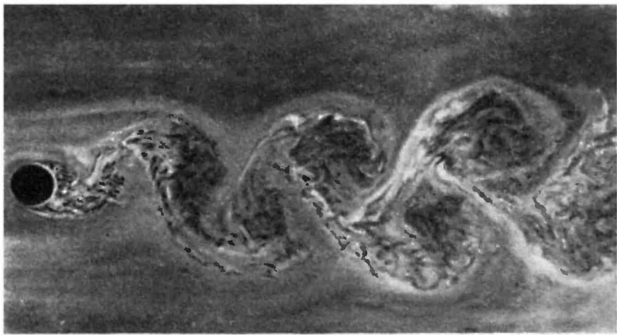
Рис. 2.11.2. След за круговым цилиндром, визуализированный частицами, плавающими на поверхности воды
